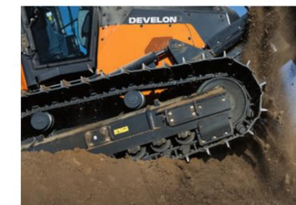
Les galets à double flasque interviennent à l'extérieur de la chaîne de chenille alors que les galets à flasque unique sont installés à l'intérieur. Cette combinaison garantit que la chenille reste sur le châssis inférieur, ce qui réduit l'usure et améliore le confort de l'opérateur.
