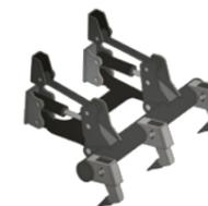
Les bulldozers Develon sont équipés de canalisations pour faciliter l'intégration d'un accessoire de dent de dérochage à 3 porte-dents parallèle en option. L'accessoire de dent de dérochage est équipé d'une tringlerie parallèle qui aide à conserver un angle constant par rapport au sol, quelle que soit la hauteur. Cet accessoire aide à briser rapidement les matériaux durs et robustes avant le nivelage.
