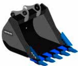
Le godet usage normal est destiné à l'excavation et au chargement de matériaux tendres à moyennement durs (c'est-à-dire des matériaux peu abrasifs tels que la terre végétale, la marnes ou le charbon).
